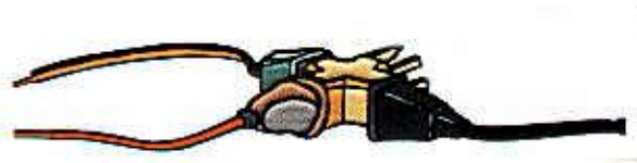
Fig. 9. Uso de alargadores y uniones múltiples indiscriminadas
